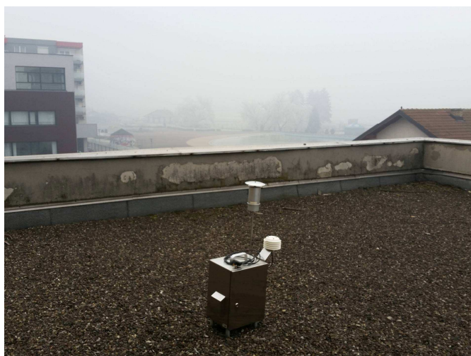
Uzorkivač zraka MVS6, Sven Leckel, na krovu (balkonu) JU „Dom zdravlja“, Ilidža
